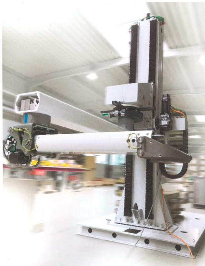
Bild 1 Für einen Medizintechnik-Hersteller hat Leantechnik eine Hubsäule konstruiert, die in der Qualitätsprüfung von Deckenversorgungseinheiten zum Einsatz kommt.
